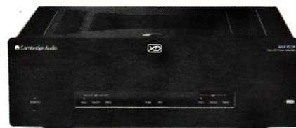
*Ecco il nuovo 'due telai' stereo Azur di alte prestazioni, il pre totalmente bilanciato 851E e il finale ultrapotente 851W con 24 transistor finali che può anche essere impiegato 'a ponte'.*
