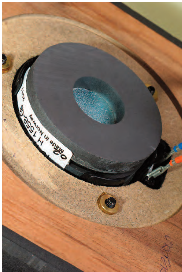
Il gruppo magnetico del tweeter da 25 mm montato sulla piccola P3
