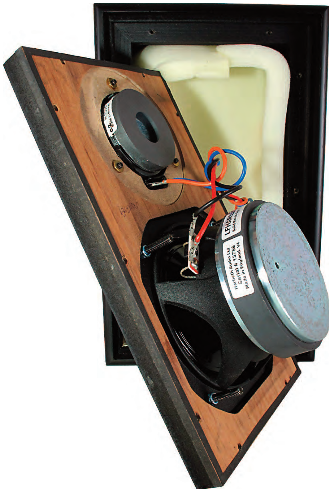
Il pannello anteriore smontato, su questo sono avvitati i due trasduttori della P3ESR
