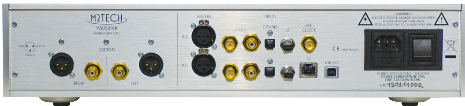
Il pannello posteriore esibisce un'ampia varietà di prese di collegamento; a sinistra le uscite analogiche bilanciate e sbilanciate; al centro gli ingressi digitali elettrici bilanciati AES/EBU e S/PDIF, con doppio connettore BNC e RCA, seguiti dagli ingressi digitali ottici Toslink e i più pregiati ST. Infine le prese I2S, USB 2.0 e BNC per il clock esterno.
