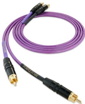
Cavo di interconnessione analogico schermato, 6 conduttori 26AWG argentati 99.999 OFC, isolamento FEP.
