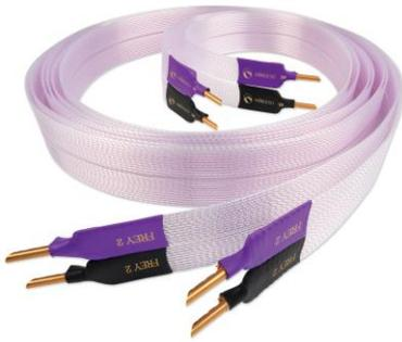
Cavo per diffusori piatto, 22 conduttori 22AWG argentati 99.999 OFC, costruzione Micro Mono-Filament.
