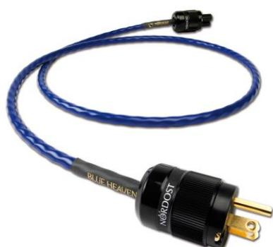
Cavo di alimentazione 15/20 Amp IEC, costruzione Micro Mono-filament, 2 conduttori 16AWG 65 99.999 OFC, guaina FEP
