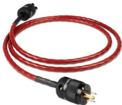
Cavo di alimentazione 15 Amp IEC, costruzione Micro Mono-filament, 3 conduttori 14AWG 65 99.999 OFC, guaina FEP
