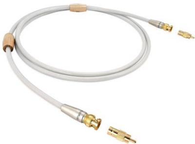
Cavo di interconnessione digitale 75 Ohm S/PDIF, design coassiale conduttori argentati 99.999 OFC, costruzione DUAL Mono-Filament, terminazione BNC con adattatore RCA incluso.
