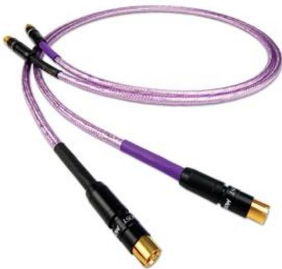
Cavo di interconnessione analogico schermato, 5 conduttori 24AWG argentati 99.999 OFC, costruzione Micro MonoFilament. **Disponibile con terminazione Nordost MoonGlo RCA o Neutrik XLR**
