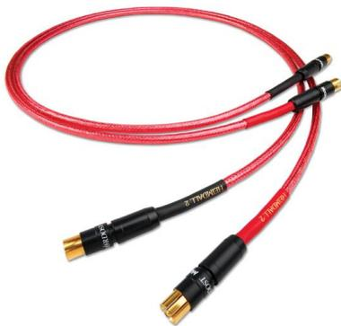
Cavo di interconnessione analogico schermato, 4 conduttori 24AWG argentati 99.999 OFC, costruzione Micro MonoFilament. **Disponibile con terminazione Nordost MoonGlo RCA o Neutrik XLR**
