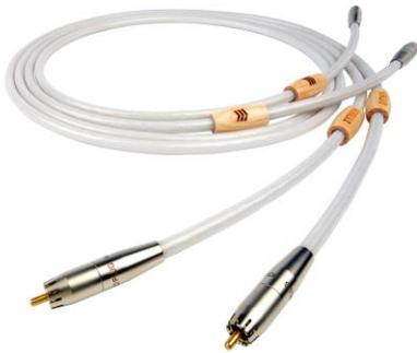
Cavo di interconnessione analogico schermato, 10 conduttori 24AWG argentati 99.999 OFC, costruzione DUAL Mono-Filament.
